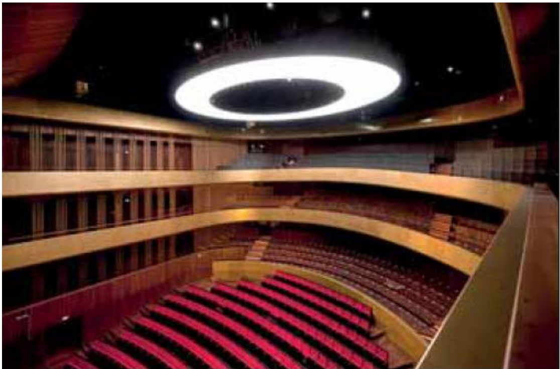
Modell 1:10 für messtechnische Voruntersuchungen
