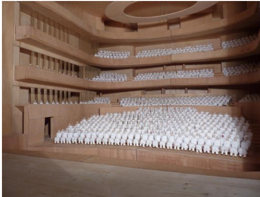
Modell 1:10 für messtechnische Voruntersuchungen
